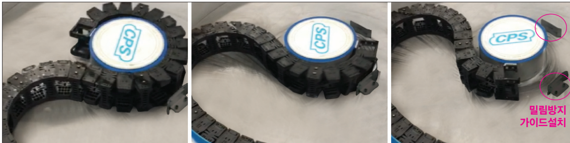
가이드 적용 (밀림 현상 없이 안정적으로 구동) 불안정한 구동에 의한 체인 파손 방지 내구성 향상
