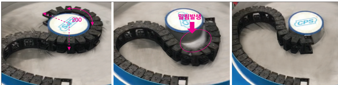
Revolving Chain 특성 상 회전 시 입선 중량 및 회전 반경에 따른 밀림 발생
